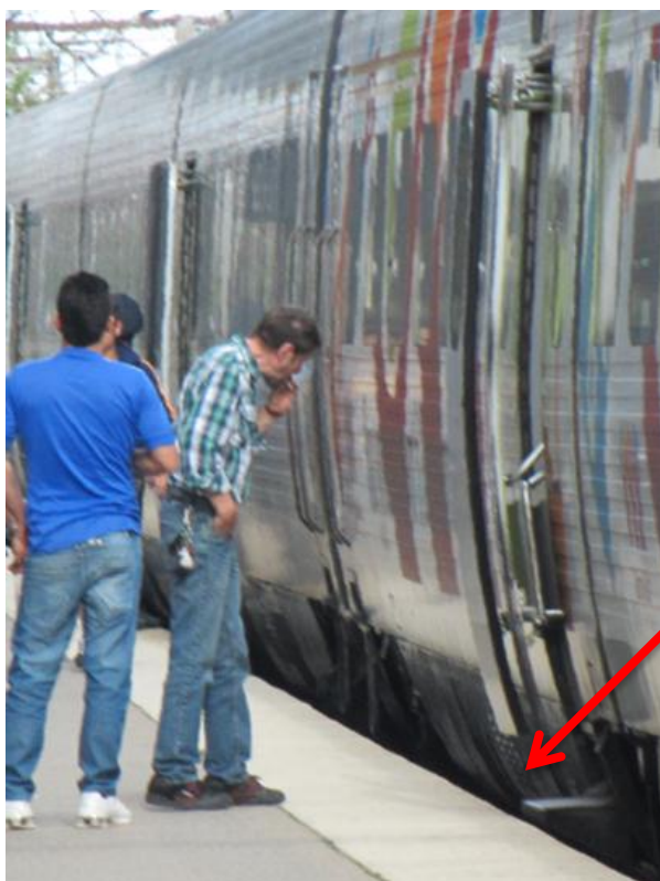
Gitterrist placeret ved siden af indgangsparti og perron
