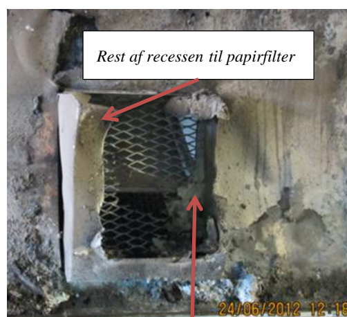
Metalgitter med hul til luftindtag for gearoliekøler
