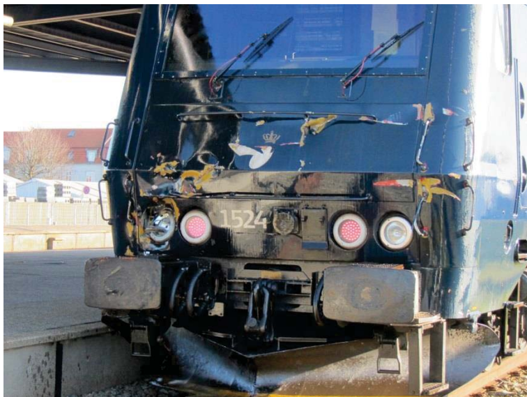
Foto 3 Skader på fronten af lokomotiver, ME 1524
