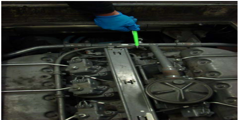
Foto 4: Brændstofslange uden brandskade
