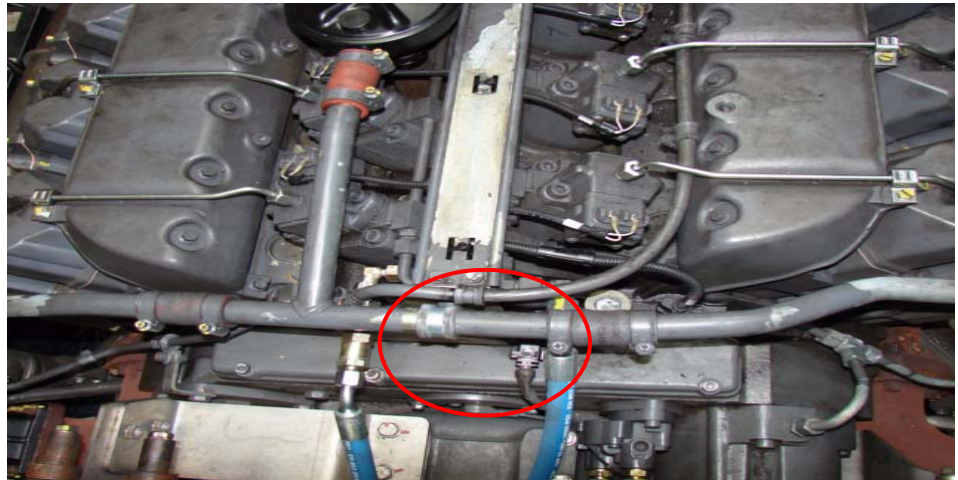
Foto 10: Normal tilstand omkring brændstofslanger, rørføringer - holder.
