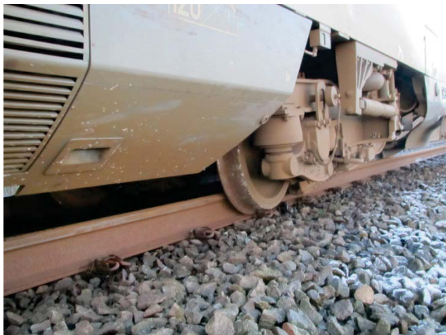
Bagerste aksel på forreste bogie, som var afsporet og beskadigede skinnebefæstigelserne.
