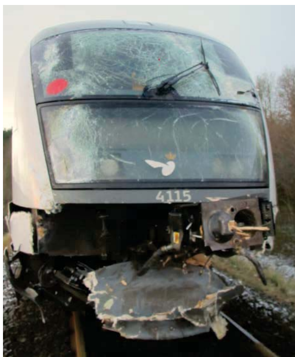
Ødelagte skørt og frontkobling m.m.
