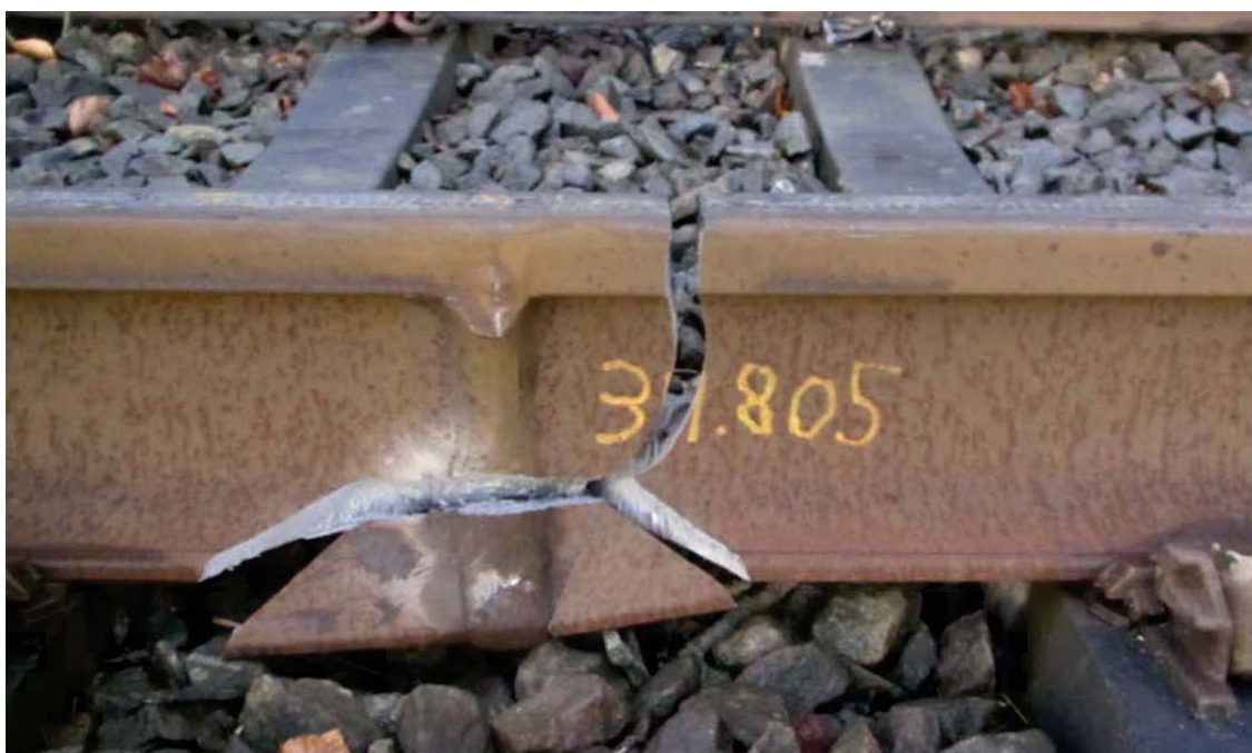
Et af de 4 skinnebrud som opstod som følge af kollisionen med træet
