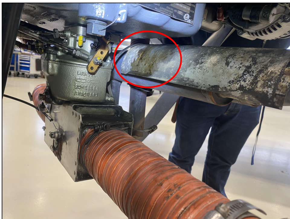
Foto 3. Oliespild på en del af udstødningssystemet.
