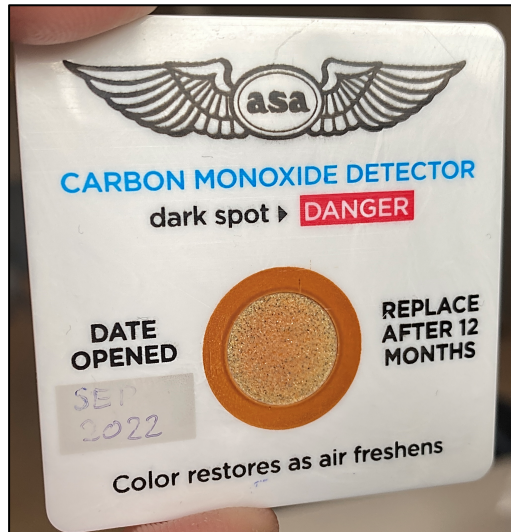
Foto 1. Ombordværende advarselsindikator for kulilte.
