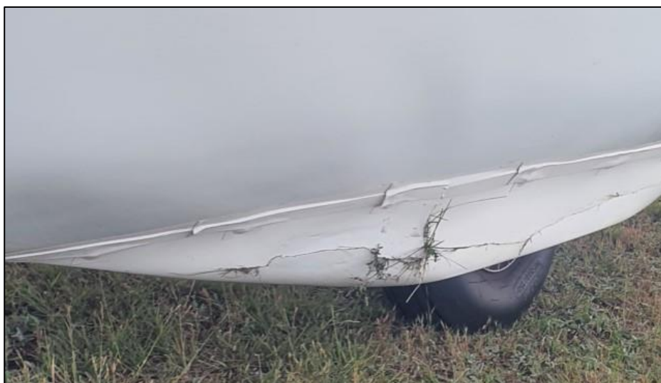
Foto 1: Skader på hovedhjulsskærm.
