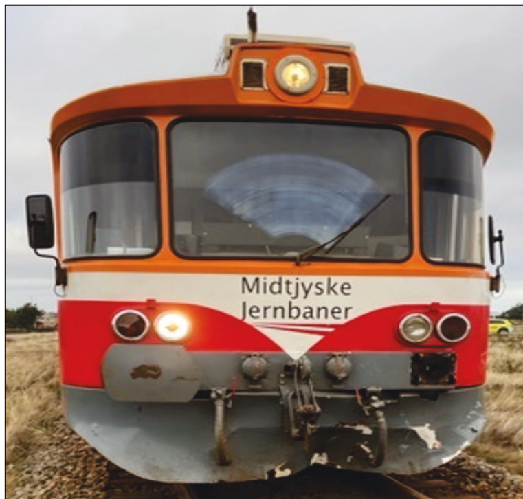
Foto 6: D. 18-01-2022, togets front med skader på banerømmer og venstre puffe mangler. Kilde: MJBA.
