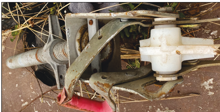
Foto 11: D. 19-01-2022, stilladsfod med hjul, der blev fundet ved uheldsstedet, med skader der sandsynligvis skyldes påkørsel/overkørsel af togets hjul.
