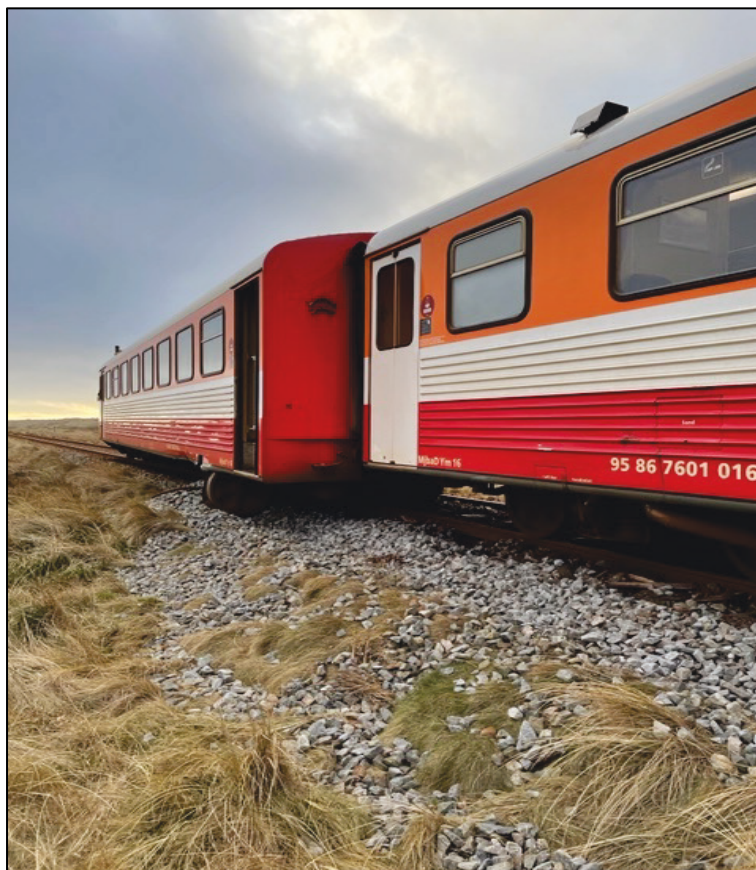
Foto 7: D. 18-01-2022, venstre side af toget set i køreretning, forreste vogns anden bogie er afsporet, vognkassen holdt skævt. Kilde: MJBA
