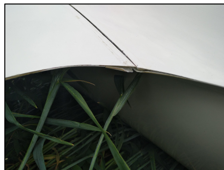
Foto 2. Delamineringer på venstre vinges bagkant og venstre kåbe.
