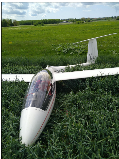
Foto 1. Svæveflyet på havaristedet. Kroppen er brudt bag cockpittet.
