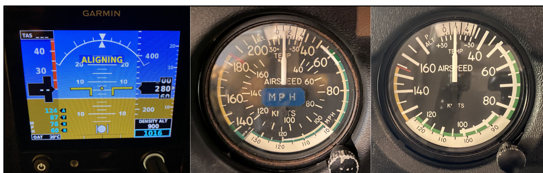
Figur 4. Til venstre: En Garmin G5 fra en PA-28-151 med en speedtape hastighedsindikation i mph. I midten: En ASI fra en PA-28-151 med en primær flyvehastighedsindikation i mph og sekundært i kt. Til højre: ASI fra OY-RFK med en flyvehastighedsindikation udelukkende i kt.
