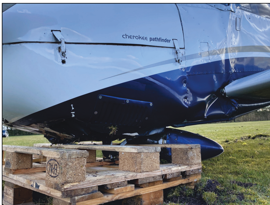
Foto 2. Skader på næsehjulsunderstøtelsen, flykroppen og vingen.
