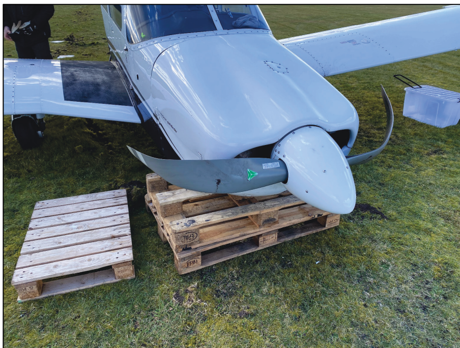
Foto 1. Skader på propellerblade.
