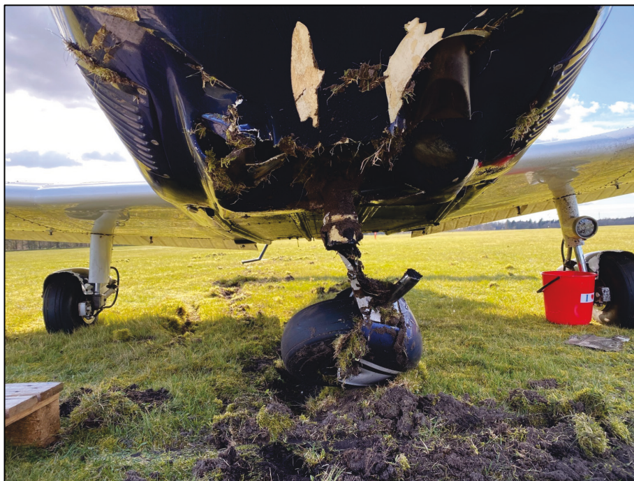
Foto 3. Brudt næsehjulsunderstelsben, beskadigede hjulskærme og skader på undersiden af motorskærmen.
