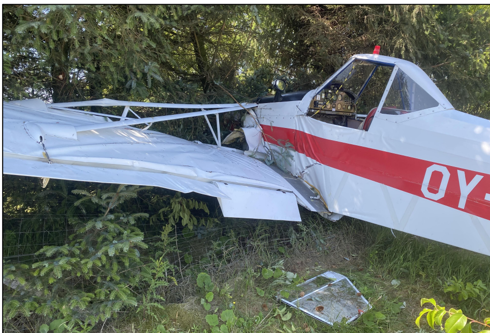
Foto 1. Skader på flyets venstre vinge og flykroppen.
