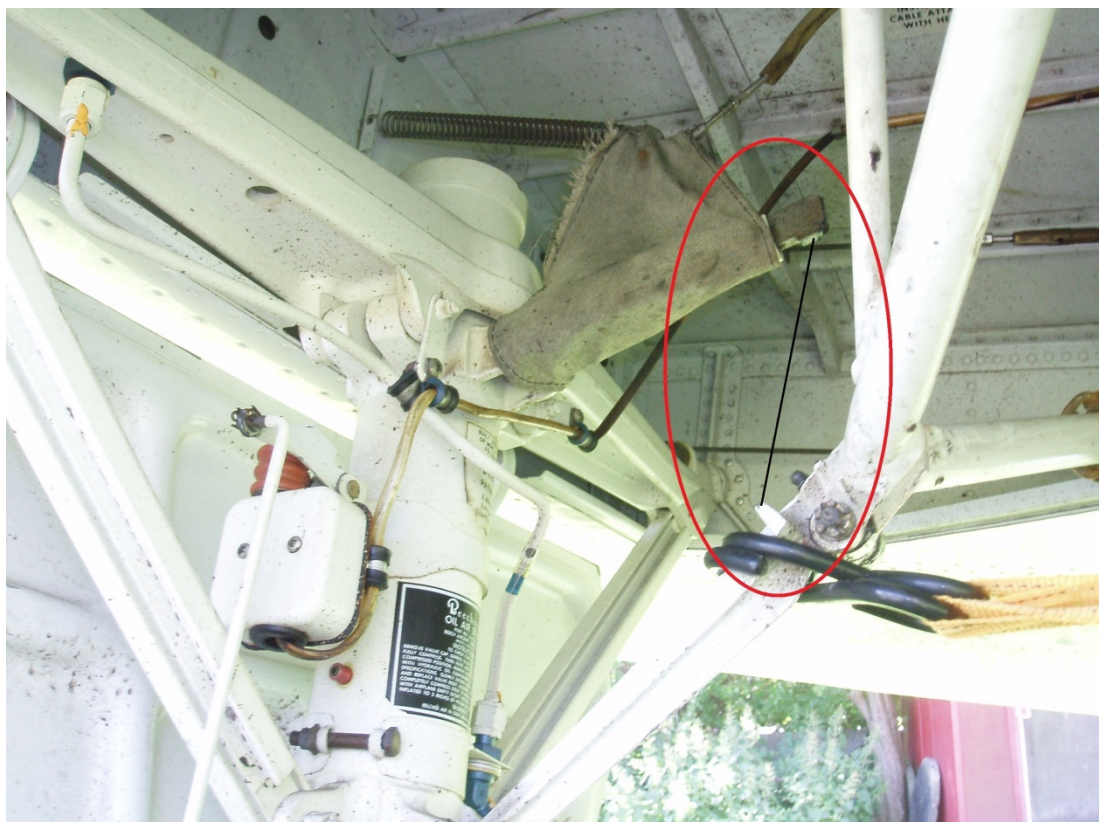
Bilag B. Højre hovedunderstel med defekt låsemekanisme.
