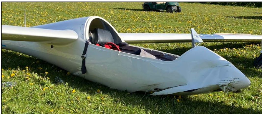
Billede 1. Skader på svæveflyets næse- og cockpitsektion
