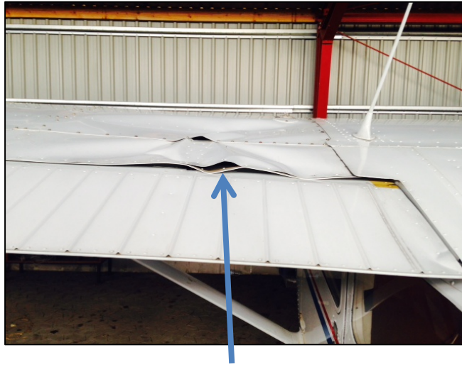
Skader på venstre vinges bagkant
