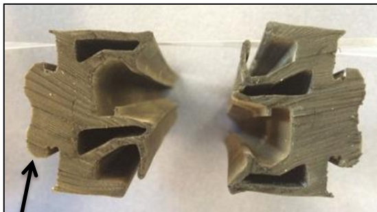
Gummilisteprofil monteret i dørbladet, langs dørkanten
