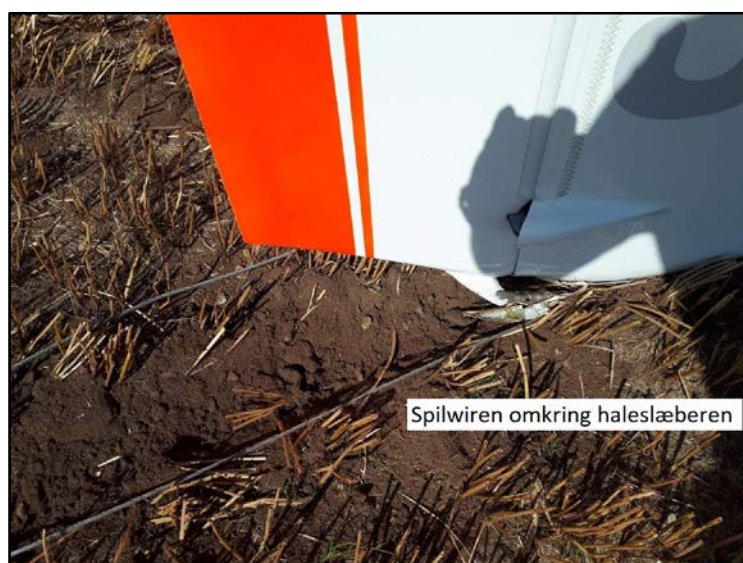
Ovenstående foto viser nederste del af haleplanet og haleslæberen, med spilwiren omkring haleslæberen.
