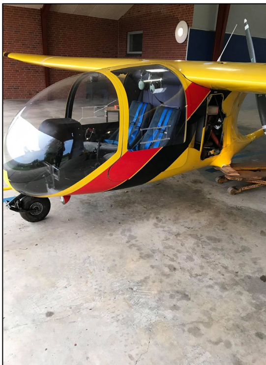
Foto 1. Flyet vist med det separerede venstre hovedhjulsunderstelsben og trykkede næsehjulsunderstelsben
