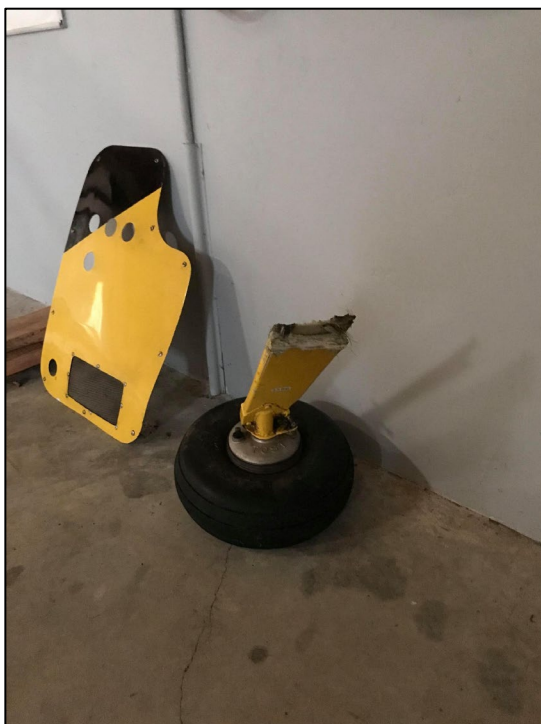
Foto 2. Det separerede venstre hovedhjulsunderstelsben
